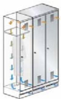
Durch den optimierten Strömungsverlauf funktioniert die Belüftung ohne zusätzliche Lüftungseinrichtungen. Selbst bei Schränken mit Sockel ist eine gleichmäßige Belüftung des gesamten Innenraumes gewährleistet!
