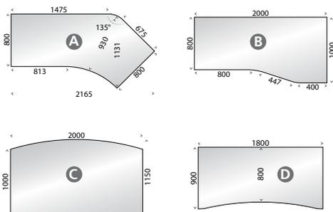
**Schreibtische mit Freiformplatten und Rasterhöhen-einstellung**
